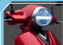
Hệ thống đèn pha, đèn hậu LED
